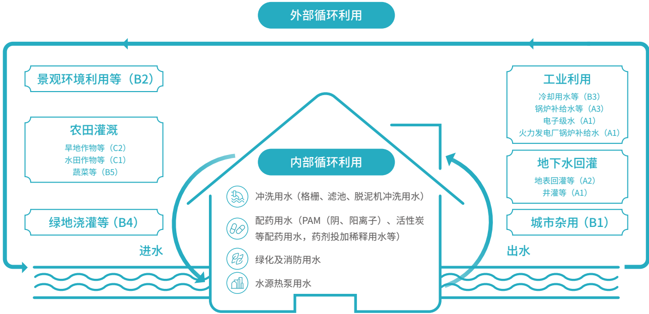
污水处理厂内外再生水双循环利用示意图
